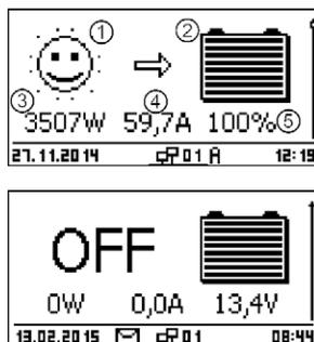
① El símbolo módulo solar/instalación muestra el estado del módulo solar y de la instalación de la siguiente manera:
