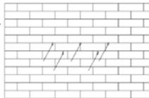
Inserte los tubos de expansión en los agujeros y apriételos. Instale el soporte con los tornillos de expansión.
